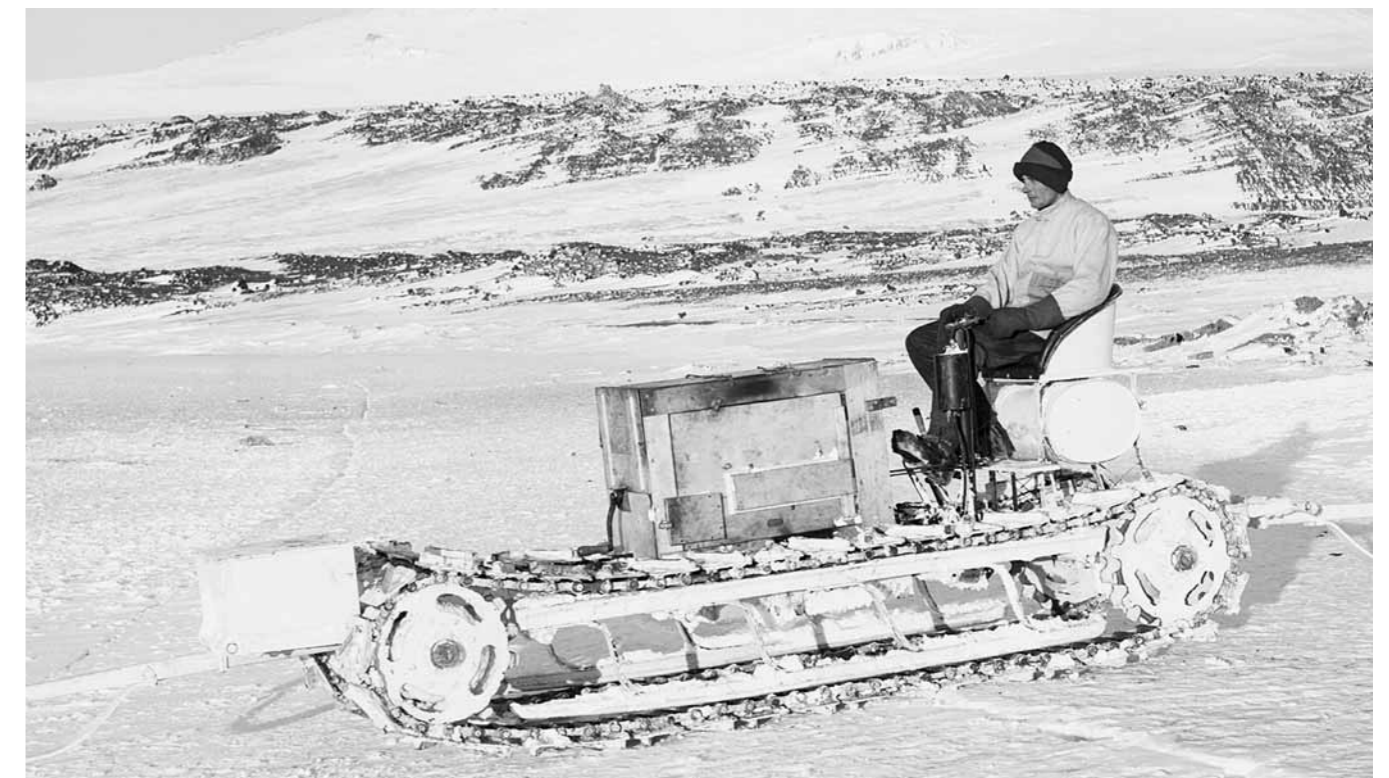
Scotts Kettenfahrzeuge waren zu schwer und pannenanfällig. Eines versank im Meer, die beiden anderen hatten Motorschäden.
