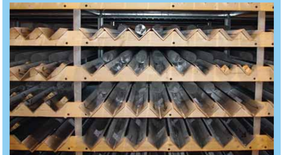
Die Bohrkern liegen gekühlt zum Untersuchen bereit.
